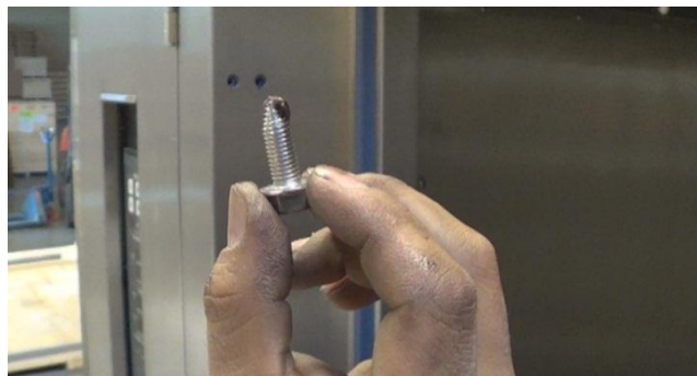
7) Use Anti-seize compound / Utilisez Anti-grippage / Use compuesto antiadherente
