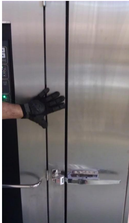
31) Install the door, check the gap / Installez la porte, vérifiez l'écart / Instale la puerta, compruebe la brecha
