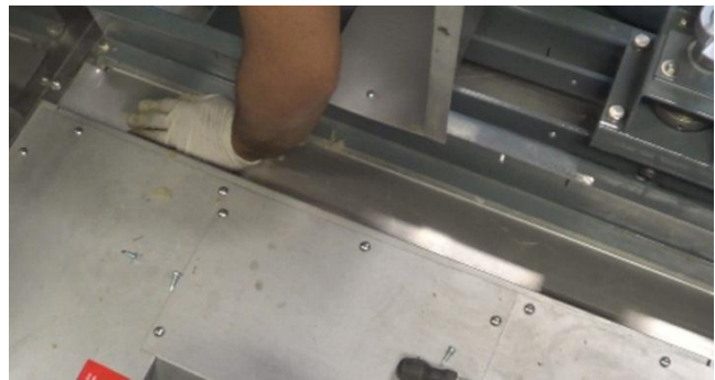
12) Install top cover / Installez le capot supérieur / Instale la cubierta superior
