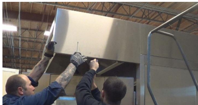
45) Install hood sides / Installez côtés du capot/ Instale los lados del capó
